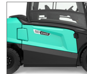
Portello laterale vano batteria
